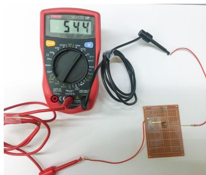
9.attēls. Air-gen ģeneratora spriegums (544 mV) var darbināt mazas elektroniskās iekārtas (kalkulatoru, viedtālruni u.c.)
